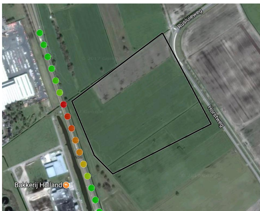
Figuur 4: Heat map van reflecties. De bollen geven de geanalyseerde weglocaties aan op de N36; de zwarte contour geeft het PV-park aan.
